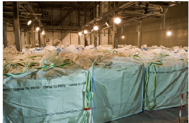
Etat actuel : Colis final de 1 m 3 , entreposé en cours d'évacuation vers les stockages de déchets
