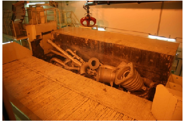
Equipements d'enrichissement dans la presse cisaille pour broyage
